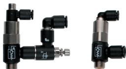
Montés par paire, les raccords stop-vérin s'implantent directement sur le vérin. Leur totale orientabilité apporte une grande souplesse pour la réalisation des circuits pneumatiques.
