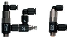
Las válvulas anti-retorno pilotadas están destinadas a proteger las instalaciones: en caso de corte de la llegada de aire comprimido, bloquean la alimentación del cilindro y lo mantienen así- en su posición.
