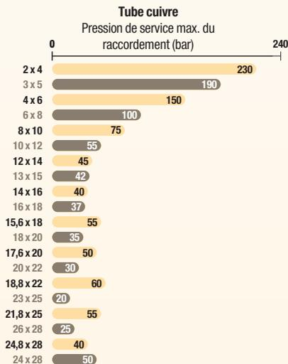
Montage réalisé avec bague Parker Legris acier traité et écrou acier traité (série à suffixe 40).
