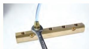
Avvitare il dado con la chiave, in modo da ottenere il serraggio dell'ogiva sul tubo; il collegamento è realizzato quando viene raggiunta la coppia di serraggio consigliata (consultare le tabelle qui di seguito)
