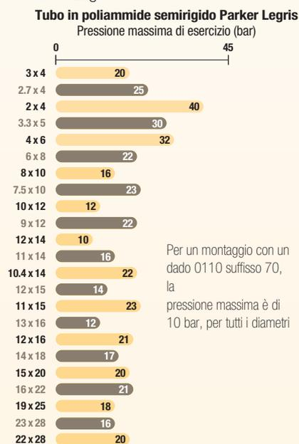
Per un montaggio con un dado O110 suffisso 70, la pressione massima è di 10 bar, per tutti i diametri
