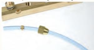
Far scivolare il dado sul tubo; lubrificare la filettatura del corpo, l'ogiva e la filettatura del dado per facilitare il serraggio (idem per la versione inox); montare l'ogiva sull'estremità del tubo.
