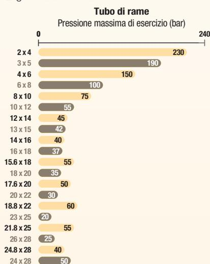
Montaggio realizzato con ogiva Parker Legris in acciaio trattato e dado in acciaio trattato (serie con suffisso 40).
