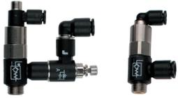
• Gesteuerte Rückschlagventile sperren den Durchfluss konsequent und vollständig in einer Richtung und schützen ihre Anlage. Bei Unterbrechung der Druckluftversorgung blockieren Sie die Zuluft zum Zylinder und halten ihn dadurch in seiner Stellung.
