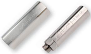
Regelbare Rückschlagventile aus vernickeltem Messing gewähren den Durchfluss von Druckluft in eine Richtung und sperren ihn in Gegenrichtung.
