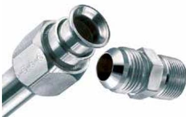
Les raccords Triple-Lok® supportent jusqu'à 500 bar avec un facteur 4. Normes : ISO 8434-2, SAE J514. Tous les raccords ont une surface sans Cr(VI). Première apparition de rouille blanche au bout de 120 h, soit mieux que les normes industrielles.
