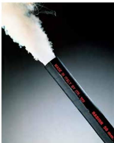
Fabriqués avec des mélanges de caoutchouc formulés pour résister à l'effet de la vapeur, les tuyaux Parker répondent aux dernières normes internationales. Des renforcements spéciaux textile et acier permettent une grande marge de sécurité pour les hautes pressions et hautes températures. La robe extérieure est résistante à l'abrasion, au vieillissement et à la chaleur.
