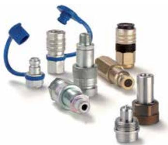
Coupleurs rapides alliant les performances d'utilisation (haute pression) et des avantages de conception éprouvés : clapet plat pour une réduction des pertes, accouplement par vissage pour connexion sous pression, verrouillage à billes pour un montage aisé et rapide. La plupart des séries sont interchangeables.
