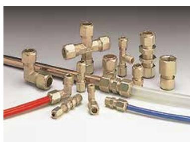
Metrulok est un raccord livré assemblé prêt à l'emploi, utilisable indifféremment avec tube cuivre ou tube plastique. La bague est sertie dans l'écrou. Les raccords Metrulok sont réutilisables.
